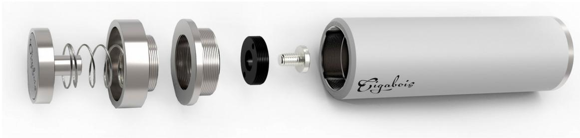
Le mod mécanique Phileas utilise une connexion 510 dite « hybride » : l'accumulateur est en contact direct avec le plot central de l'atomiseur. Pour cette raison et afin d'éviter un court-circuit il est absolument nécessaire que le plot central de l'atomiseur dépasse au minimum de 0,4 mm de l'atomiseur lui-même. Les accumulateurs utilisés devront par ailleurs être dans un parfait état, sans défauts, trous ou fissures sur la gaine isolante ni déformation ou embossage des extrémités (poles).
